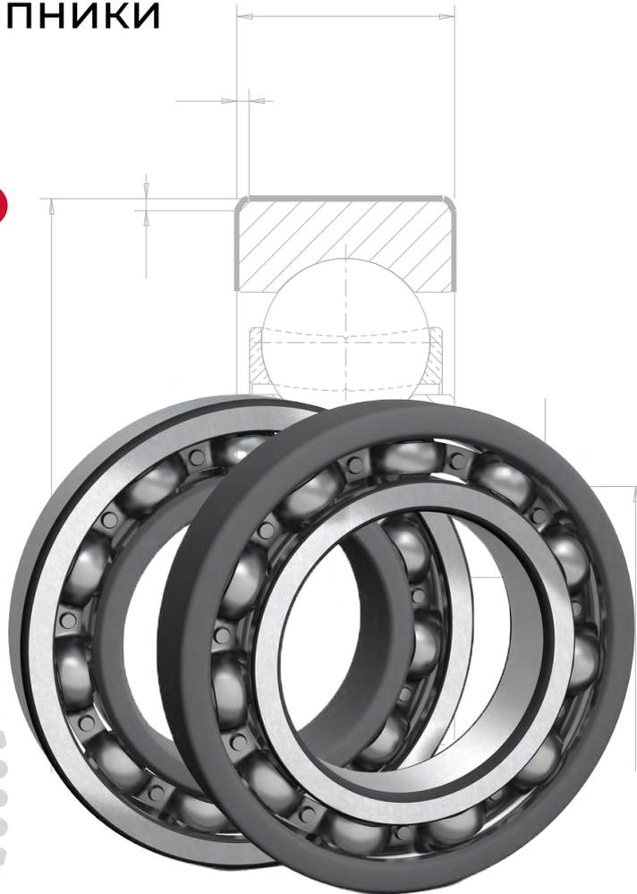
Токоизолированные подшипники имеют покрытие изолирующим слоем оксида алюминия на наружном или внутреннем кольце. Нанесение проводится посредством сложного процесса плазменного напыления.
